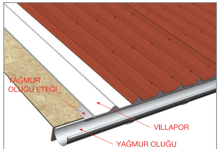
OSB ÜZERİNE HAVALANDIRMASIZ SİSTEM (VILLAPOR İLE)
