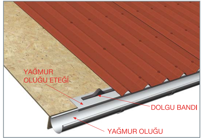
OSB ÜZERİNE HAVALANDIRMASIZ SİSTEM (VILLAPOR İLE)
