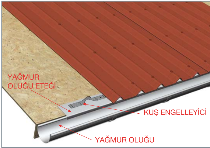
OSB ÜZERİNE HAVALANDIRMALI SİSTEM (KUS ENGELLEYİCİ İLE)
